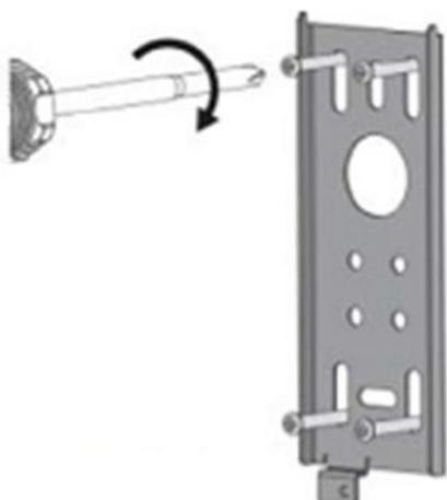
6: attaccare la placchetta di sostegno posteriore usando il cacciaviti
