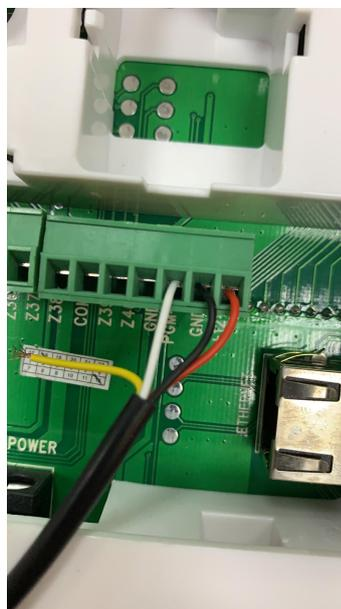
Collegamento per un corretto funzionamento a ricevere 12V +
