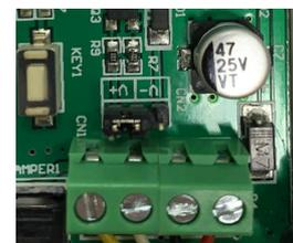
Spostare il jumper in V+ per far trasmettere il TX al ricevere dei 12V
