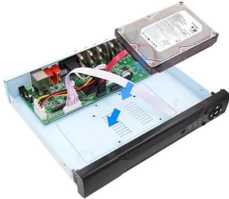
Per l'installazione del disco rigido "Hard Disk", svitate le viti poste sotto la scocca e/o lateralmente al DVR, inserire l'hard Disk negli appositi alloggi e fissare l'hard disk alla base del dispositivo mediante le 4 viti fornite in dotazione.
