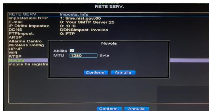
L'opzione Nuvola o P2Pp è la funzione che consente al dispositivo di collegarsi ai server di XMEYE PRO, e gestire l'impianto attraverso l'app XMEYE PRO senza dover effettuare nessuna impostazione sul router.
