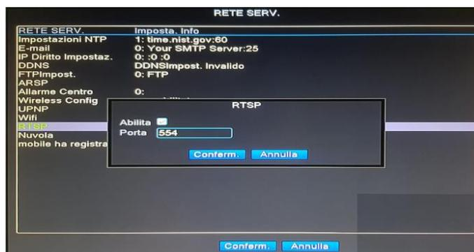
Il protocollo RTSP consente la visualizzazione dello streaming remoto mediante riproduttori multimediale che hanno la funzione di riproduzione di flussi video di rete.
