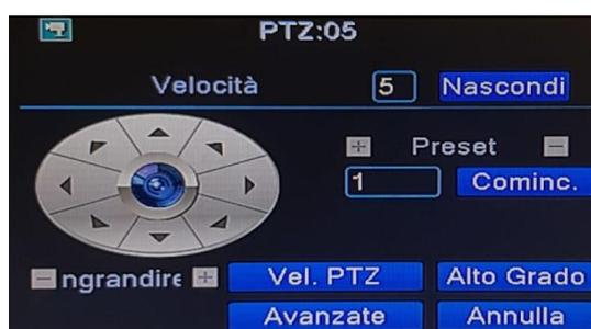
Per gestire la telecamera PTZ è possibile utilizzare il joystick come mostrato nella prima figura sopra a partire da sinistra. Per gestire inoltre lo zoom è possibile utilizzare i pulsanti posti sotto il joystick, ovviamente prima di poter gestire la telecamera è necessario configurare tutti i parametri della stessa. Vedi capitolo 9.7
